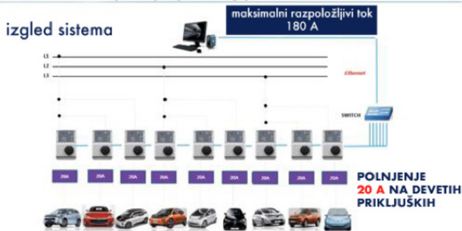
Slika 37: Shema napajanja elektro polnilnih postaj z dinamičnim upravljanjem obremenitve
